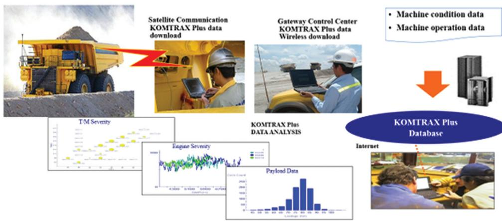
تصویر شماره ۲- مراحل کار سامانه KOMTRAX Plus
